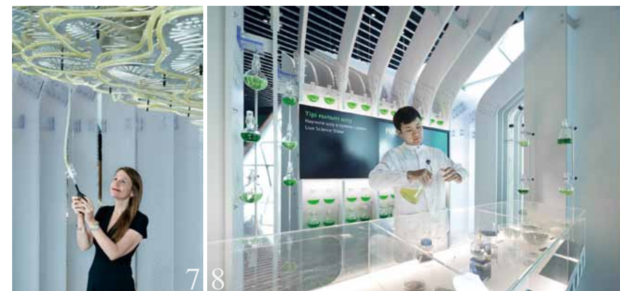
5.6.7. H.O.R.T.U.S. 是一座行光合作用菌種棲息生長的裝置，使用高速氣流將培養基推送至玻璃試管中，造成活躍的液態渦流，催化一氧化碳/二氧化碳的交換，接著液體因重力而下降，完成循環。 8. 用以生產超級食物和生物能源的庭園小屋，裝設有藻類生物攝影-反應器房，培養向光性微生物，透過光合作用製造生物質和氧氣，再轉化為食物和電力。
